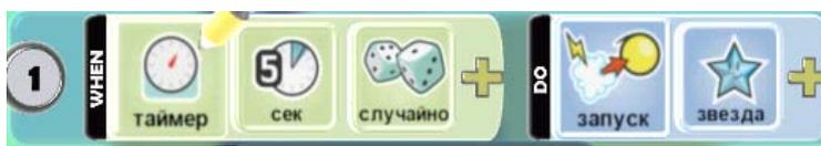
Рис. 3.2. Пример кода, когда таймер срабатывает случайным образом в интервале между 0 и 5 секундами
